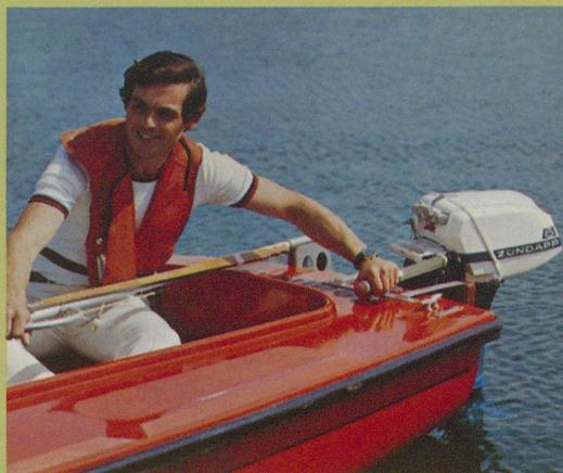
**Bootsmotor:** Ein in Leistung, Bedienung und Finish optimal ausgelegter 6-PS-Bootsmotor, 85 ccm, Reversier-Handstarter, Leerlauf, Vor- und Rückwärtsgang. Wasserkühlung. Gewicht ca. 19,5 kg. Verbrauch 2,5 Liter pro Stunde. Besonders umweltfreundlich durch Mischungsverhältnis 50:1. (Ausführliche Beschreibung — Bootsmotoren-Prospekt.)
